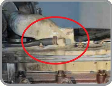
9 – Verifique el respiro del motor con relación a posibles restricciones (respiro o mangueras) o exceso de gases que puedan causar paso de aceite para el colector de admisión y escape;
