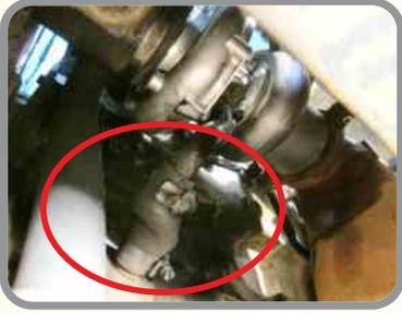
8 – Examine posibles salideros y obstrucciones en el flexible de lubricación, ductos y mangueras de retorno del aceite;
