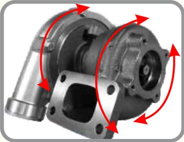
4 – Cuando sea necesario, ajuste la posición de las carcasas del compresor y de la turbina antes de posicionarlas en el motor, asegurando el correcto torque\* de aprieto de tornillos y el plegamiento correcto de las lengüetas en las trabas de fijación;
