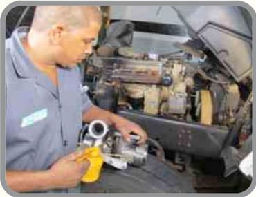
3 – Antes de la instalación del nuevo turbocargador pré-lubríquelo, girando el conjunto eje-rotor manualmente hasta que el aceite empiece a salir por el retorno;
