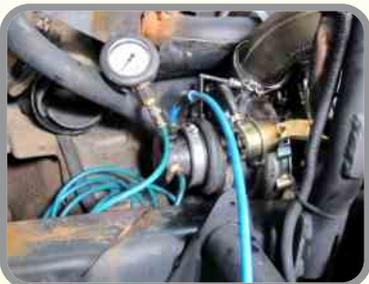
13 – Después del montaje del turbocargador en el vehículo, haga la prueba de aire comprimido (intercooler) para eliminar posibles salideros de aire en el sistema de presión (del turbocargador al motor);
