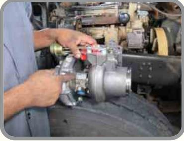
2 – Al retirar el turbocargador del embalaje, verifique si el producto no sufrió algún daño debido a accidentes en el transporte;
