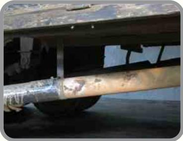
10 – Todas las conexiones de escape deben estar debidamente ajustadas, obedeciendo a los puntos de fijación original (soporte/cojín);
