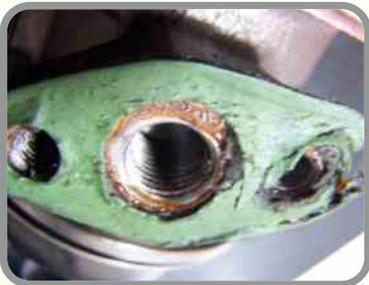
12 – Jamás utilice pegamento o sella-juntas en la instalación de las juntas de entrada y salida de aceite del turbocargador;
