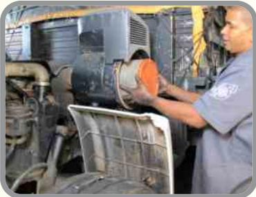
6 – Sustituya el aceite lubricante, filtro de aceite lubricante y elemento del filtro de aire conforme las especificaciones del fabricante del vehículo;
