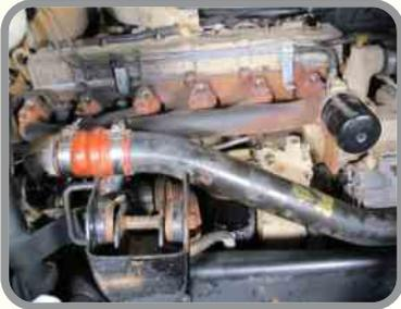
15 – Examine la manguera y el ducto del compresor de aire con relación a posibles salideros de aire, que pueden ser confundidos con salidero del turbocargador;
