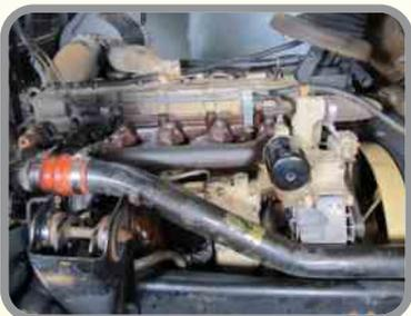
7 – Verifique si el colector de escape, la admisión, los ductos del filtro de aire, el intercooler, la manguera de admisión/presión, los anillos o-ring y las abrazaderas están en perfecto estado de funcionamiento y libres de fatiga, residuos y salideros de aire presurizado;
