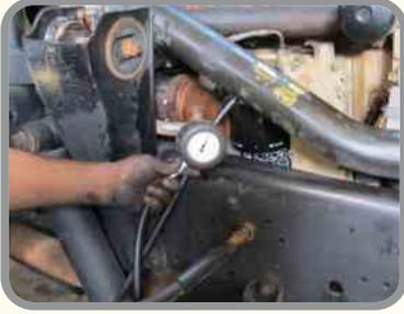
14 – Con el motor en la temperatura ideal del trabajo, mida la presión del aceite lubricante, cuyo resultado debe estar de acuerdo con las especificaciones del fabricante del motor;
